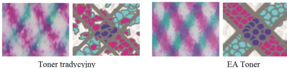
Rys. 3.40. Nadruk wykonany za pomocą tonera tradycyjnego oraz tonera wykonanego metodą EA
