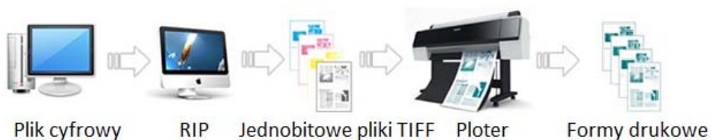
Rys. 4.25. Schemat procesu wykonania form offsetowych w technologii iCTP
