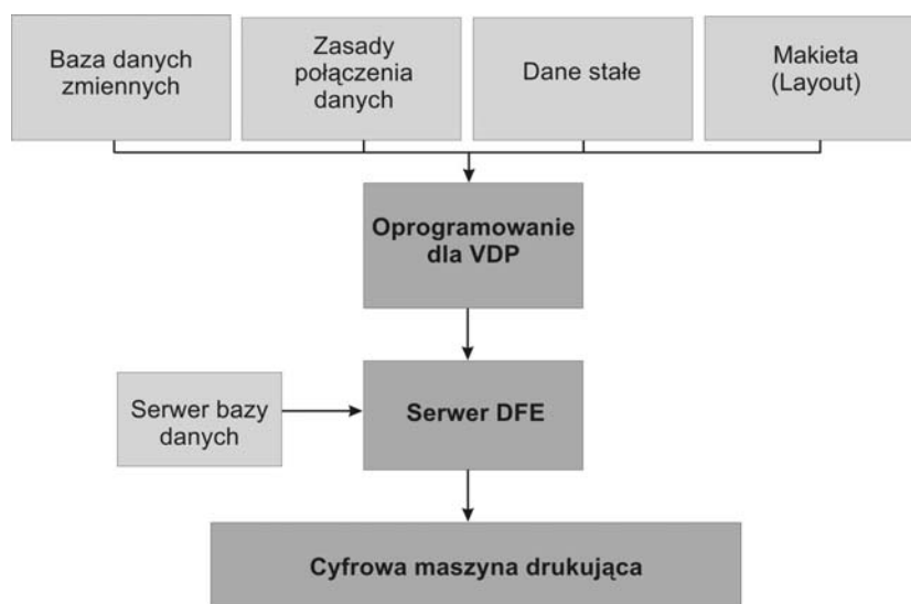
Rys. 2.2. Przepływ prac w drukowaniu danych zmiennych
