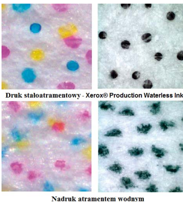
Rys. 4.38. Nadruk uzyskany w drukowaniu stałoastramentowym i za pomocą atramentów wodnych na papierze offsetowym 75 g/m 2
