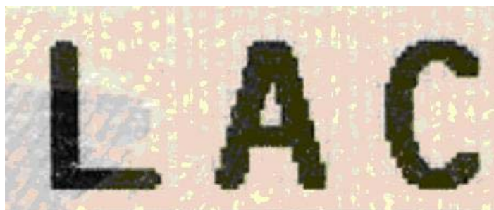
Rys. 5.7. Część powiększonego nadruku wykonanego za pomocą drukowania termotransferowego
