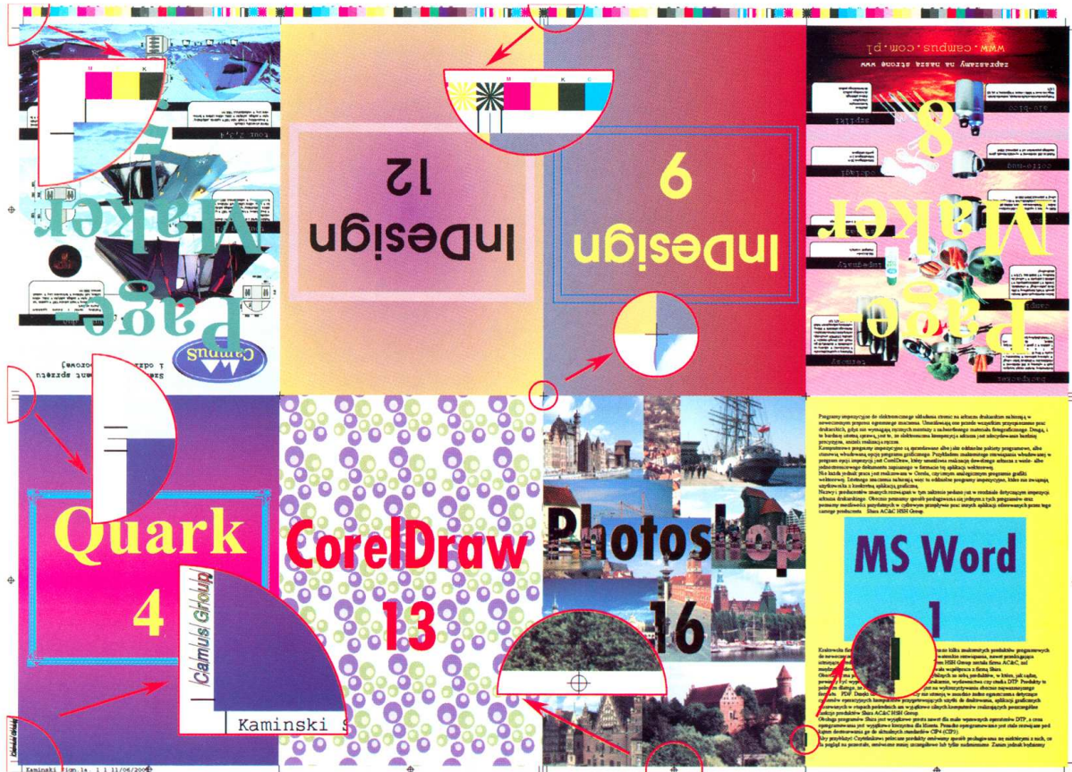
Arkusz impozycyjny jednej ze stron składki książkowej przygotowany do drukowania lub naświetlania
