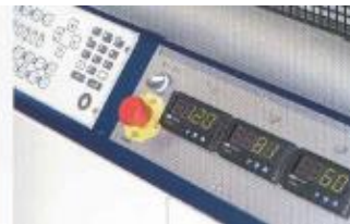
Rys. 35. Ustawienie odpowiedniej temperatury poszczególnych szyn [12]
